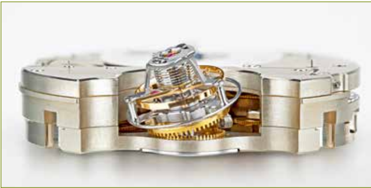
Das Kaliber Jaeger-LeCoultre 382, das die Duomètre Sphérotourbillon antreibt, verfügt über ein Tourbillon mit zwei Achsen, von denen die erste konzentrisch zu seinem Käfig und die zweite um 20° geneigt ist.
