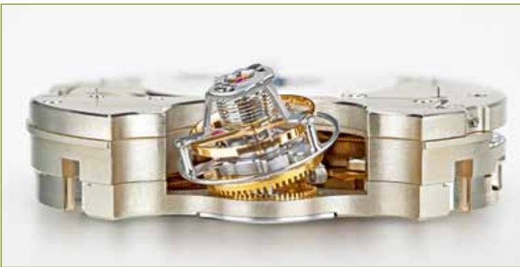
Le Calibre Jaeger-LeCoultre 382, qui équipe la Duomètre Sphérotourbillon, est doté d'un tourbillon à deux axes : le premier concentrique à sa cage, le second incliné de 20°.
